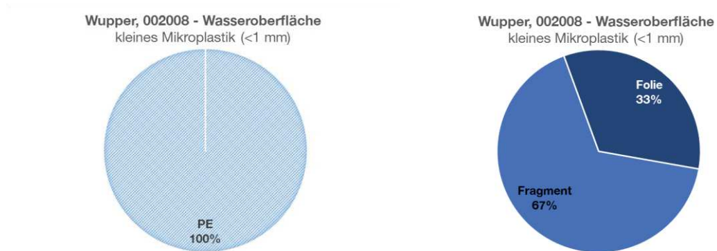
Abb. 40: Prozentualer Anteil der unterschiedlichen synthetischen Polymere (links) und der Form der kleinen Mikroplastikpartikel (rechts) in der Oberflächenwasserprobe der Probenstelle 002008.
