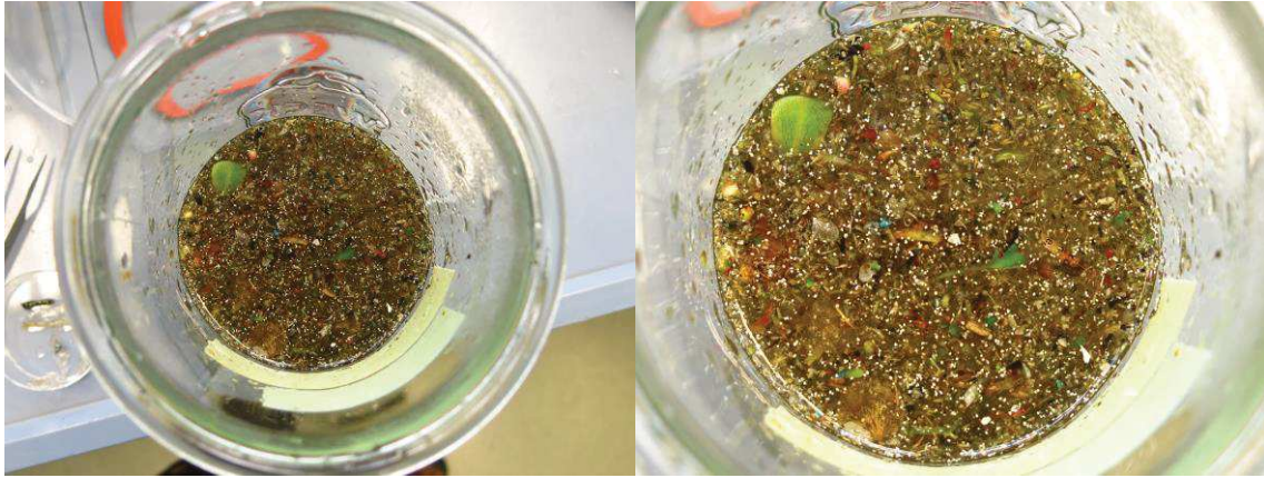
Abb. 29: Photographie der beachtlichen Anzahl an weißen Partikeln in der Probenstelle 3 der Ruhr. Bei den weißen Partikeln handelte es sich zu 90% um PP Partikel.
